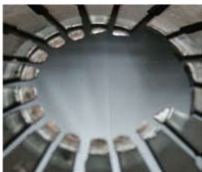
Usure excessive et bleuissement des doigts de diaphragme
