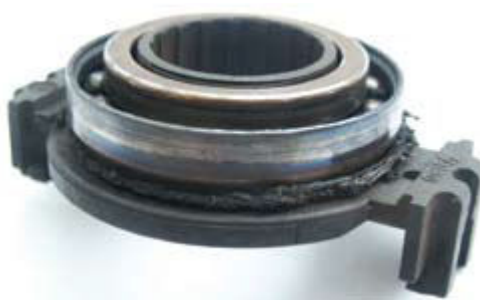
Contact avec les doigts à cet endroit, provoquant un bleuissement thermique. La bague extérieure tourne, provoquant un échauffement du support et sa fonte.
